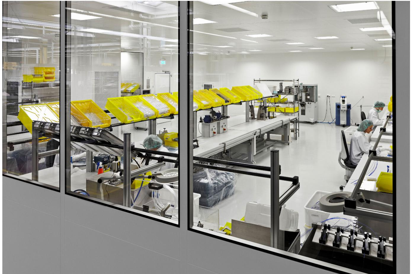
Der Reinraum ist als Insel innerhalb der Fertigungsstätte für elektromedizinische Produkte eingestellt. Er ist in den Produktionsablauf der gesamten Produktionsstätte eingebettet und stellt eine eigene Organisationseinheit, bestehend aus Umkleide, Schleuse und Verpackungsstätte, dar. Der Einbau erfolgte im laufenden Betrieb.
